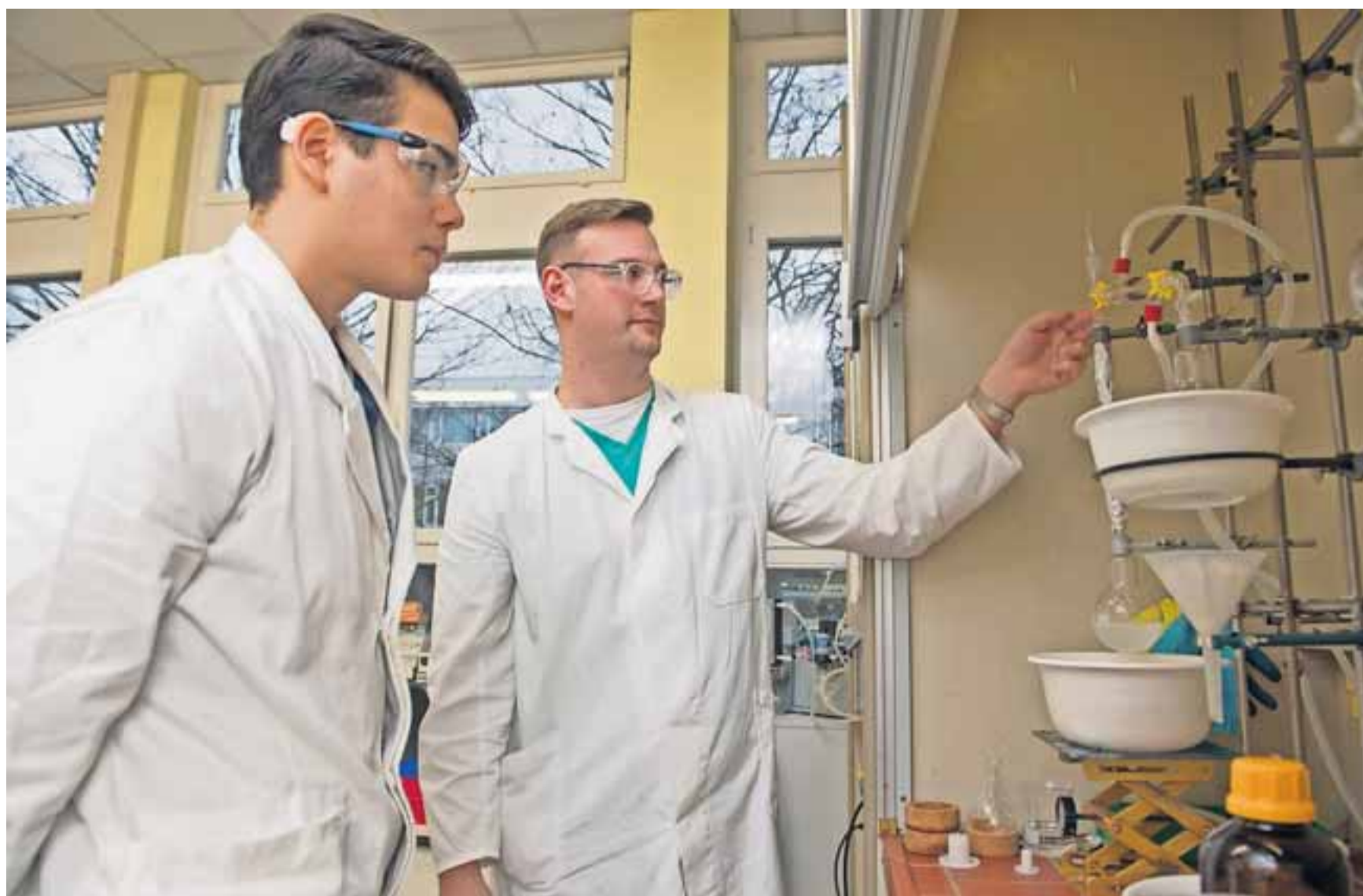
Der angehende Chemielaborant Maximilian Stahnke (links) und sein Ausbilder André Grasnack arbeiten an einer Kolonnen-Destillationsapparatur. FOTO: DPA
